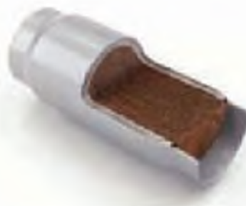
▲ Figura 14.22 Convertidor catalítico. Los automóviles están equipados con convertidores catalíticos, los cuales forman parte de sus sistemas de escape. Los gases del escape contienen CO, NO, \text{NO}_2 e hidrocarburos no quemados que pasan sobre las superficies impregnadas con catalizadores. Los catalizadores promueven la conversión de los gases del escape a \text{CO}_2 , \text{H}_2\text{O} y \text{N}_2 .
